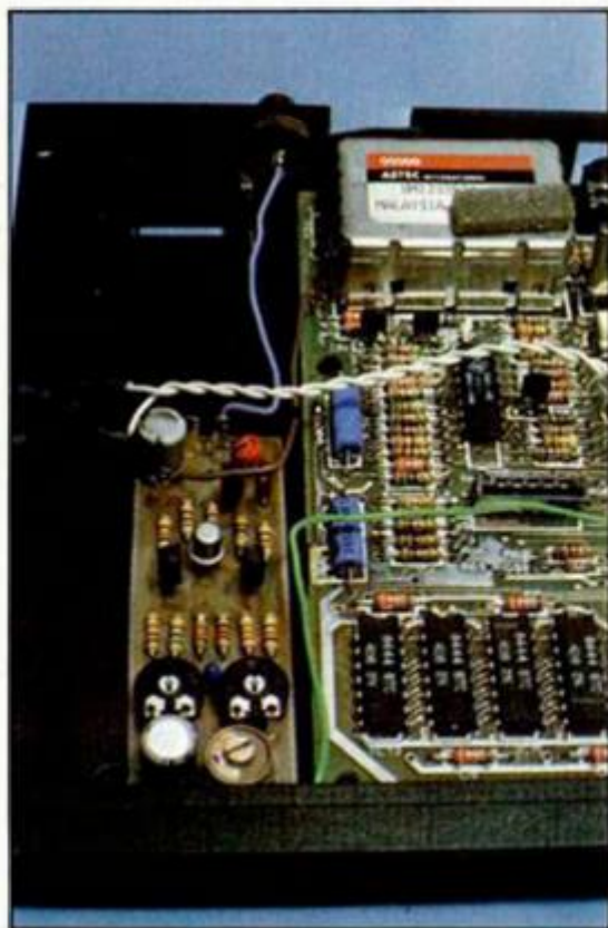
La tarjeta del amplificador de vídeo se ubicará en el hueco que existe en el Spectrum Plus cerca del modulador.
