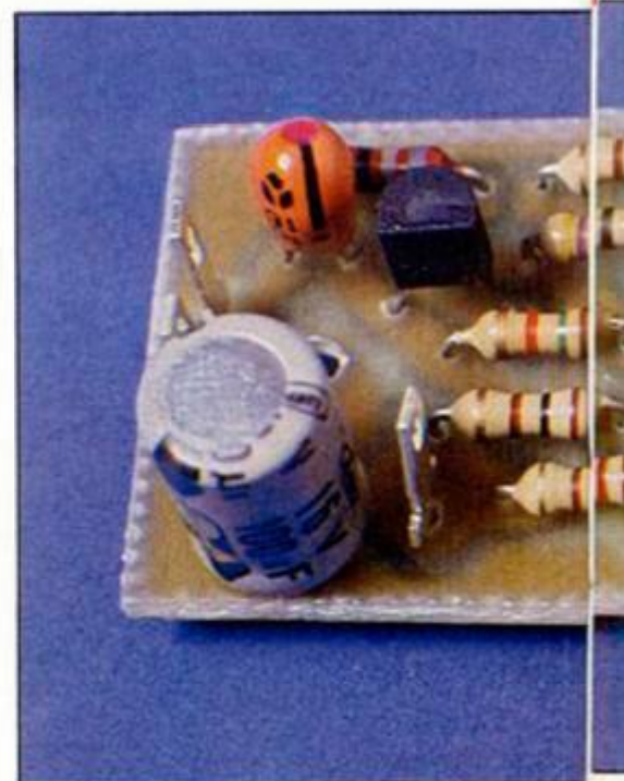
Aspecto final de la tarjeta una vez montada la totalidad de los componentes.
